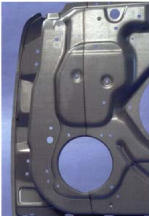
Figura 4.11 – Exemplos de peças de aço de alta conformabilidade, Catálogo Arcelor.
