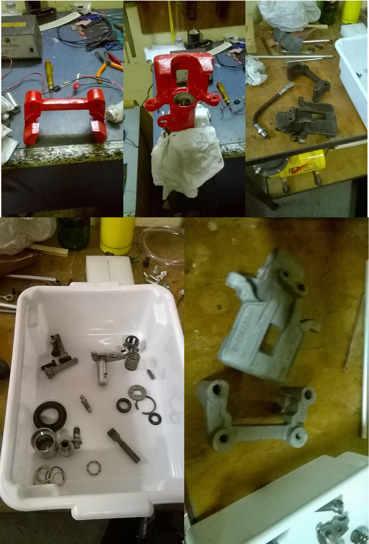
Foto 2. Pinça de Freio Traseiro Revisada
