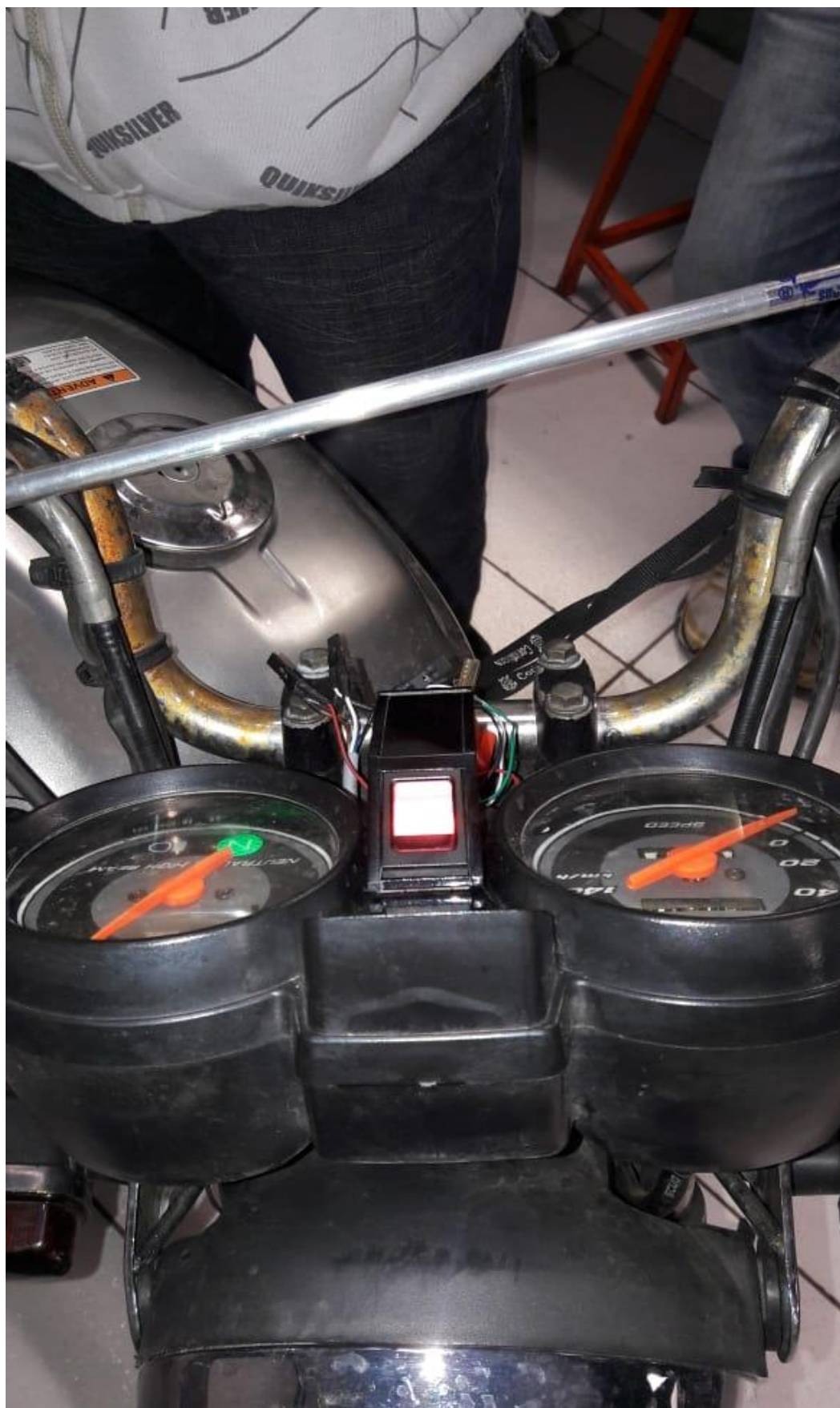
Figura 24 – Moto ligada e leitor biométrico energizado.
