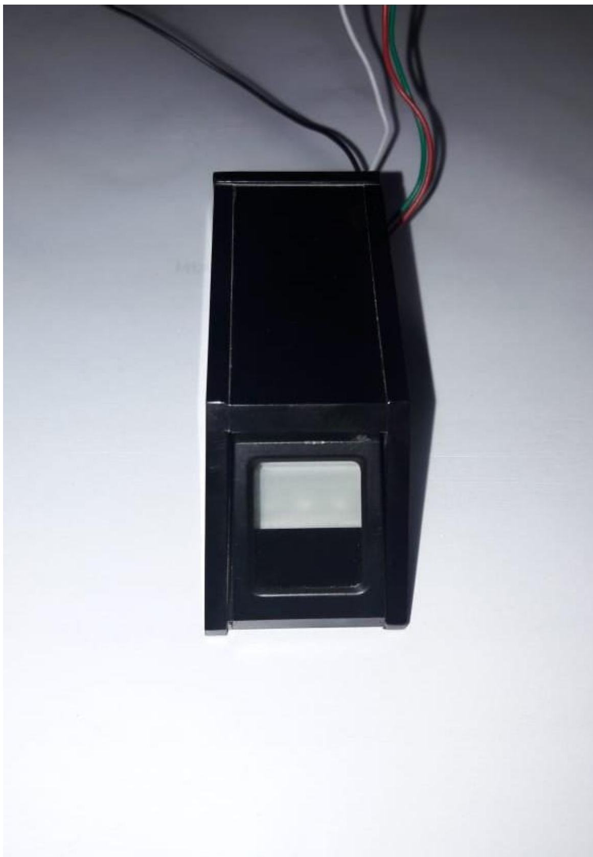
Figura 12 - Leitor Biométrico instalado no Case.
