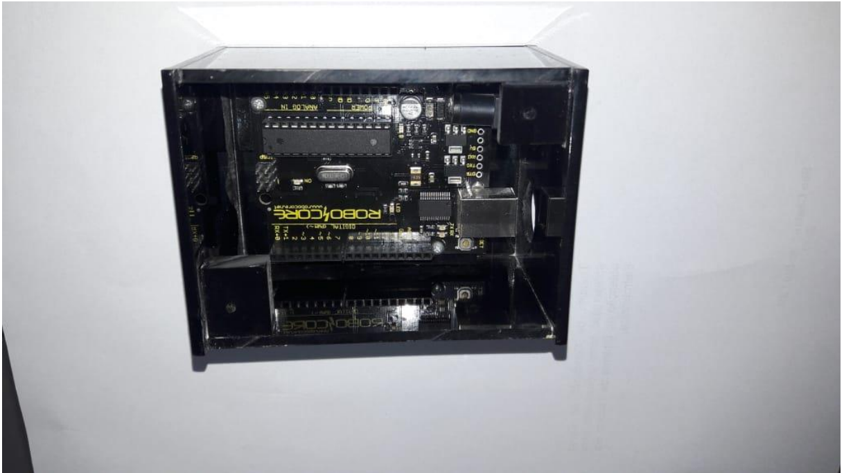
Figura 13 - Arduino fixo no case.
