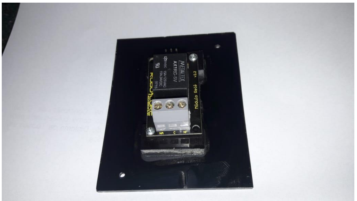
Figura 14 – Relé fixo na tampa do case.
