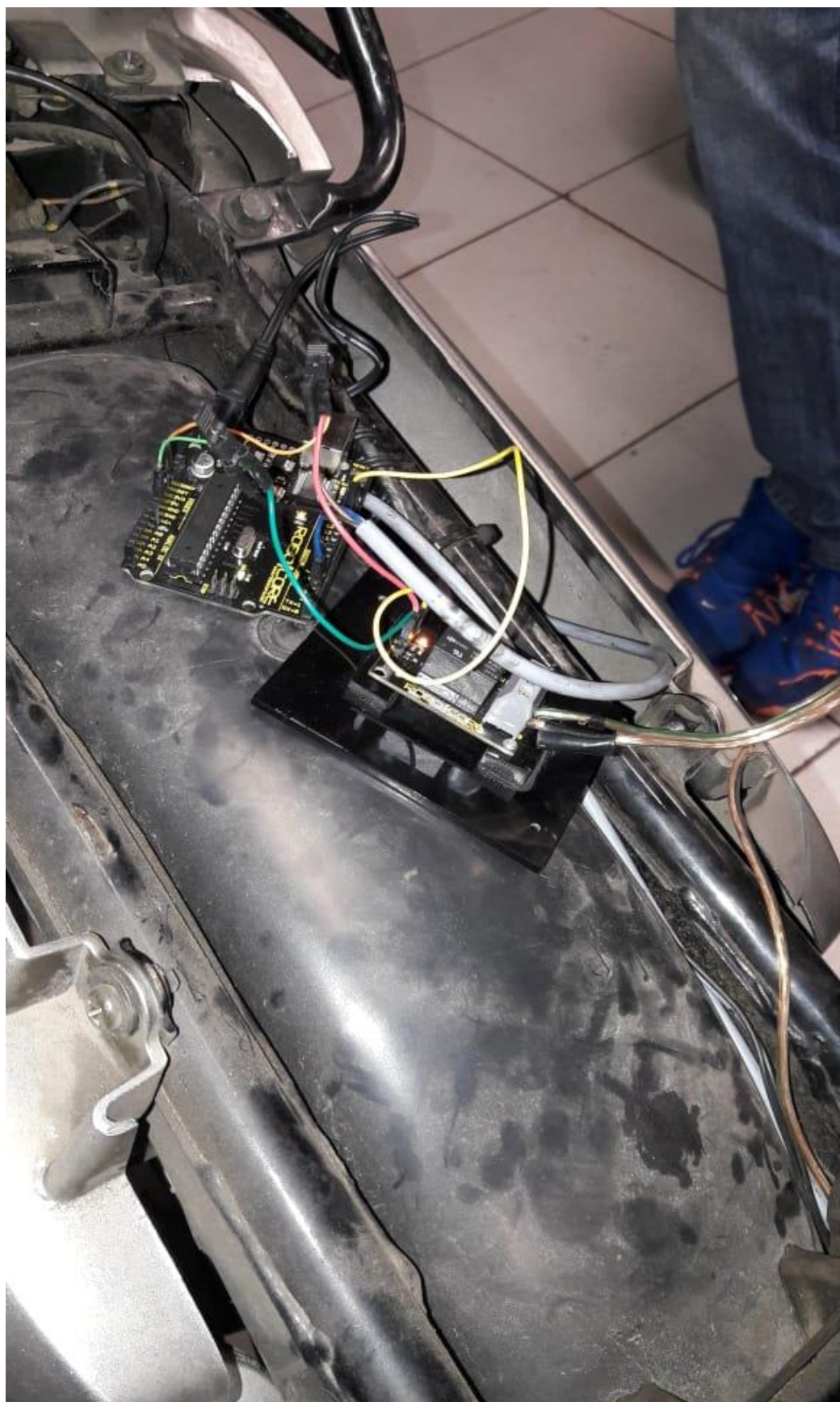
Figura 26 – Relé de partida acionado após verificação da digital.
