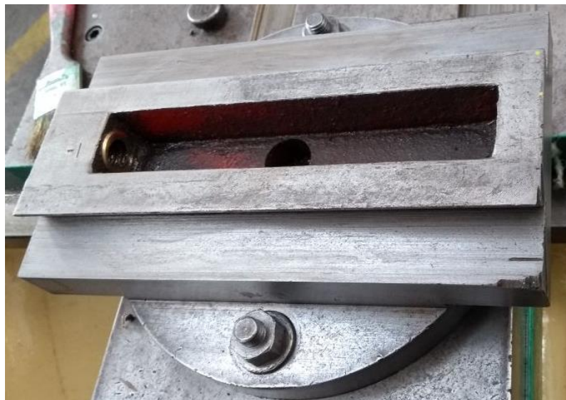
Figura 34 - Carro Superior – troca de peças e limpeza
