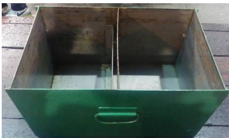
Figura 40 - Reservatório de óleo da bomba de refrigeração (Depois).
