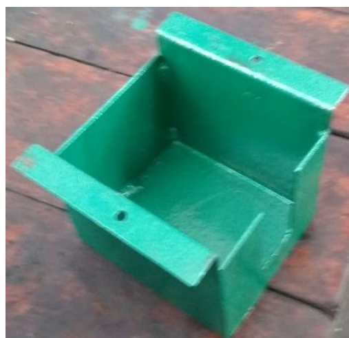
Figura 49 - Proteção da Chave Reversora - (Depois).
