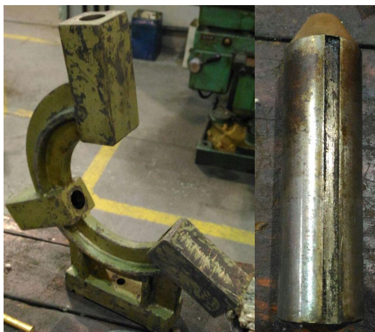
Figura 54 – Luneta Fixa preparada para a pintura e limpeza. (Antes)
