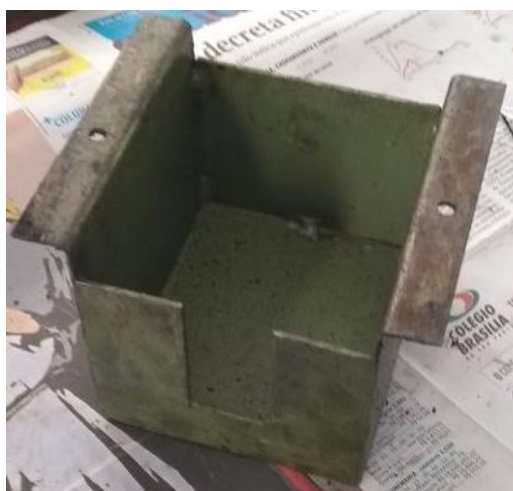
Figura 48 - Proteção da Chave Reversora - (Antes).
