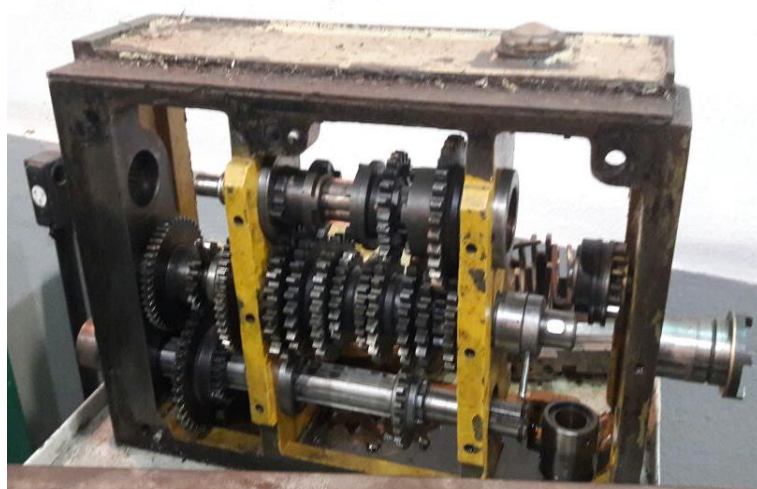
Figura 22- Caixa Norton – Desmontado
