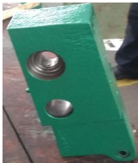
Figura 47 - Suporte de fixação do varão e fuso - (Depois).
