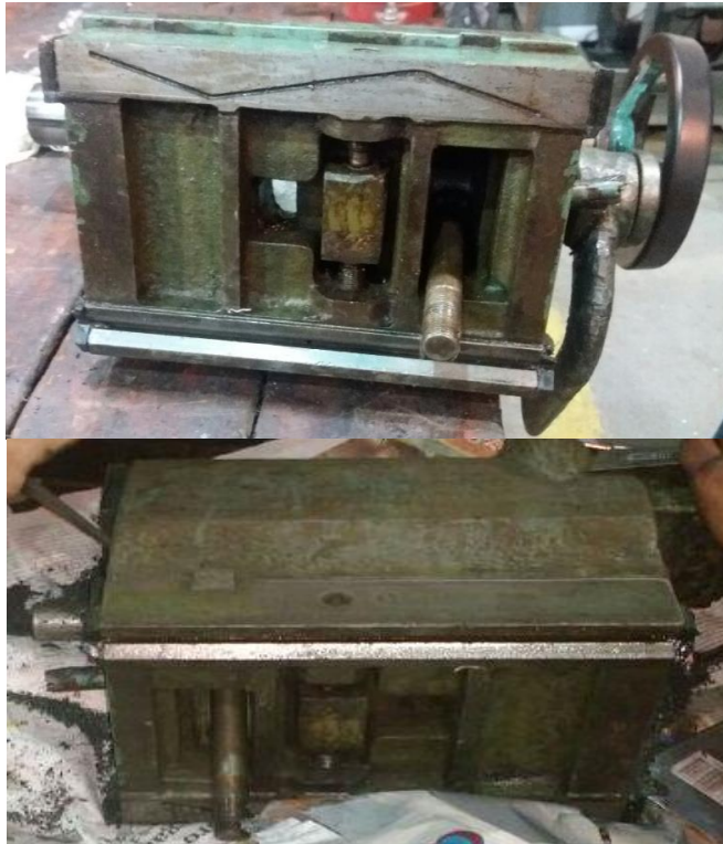
Figura 26 - Cabeçote móvel – Limpa e preparada para a pintura.
