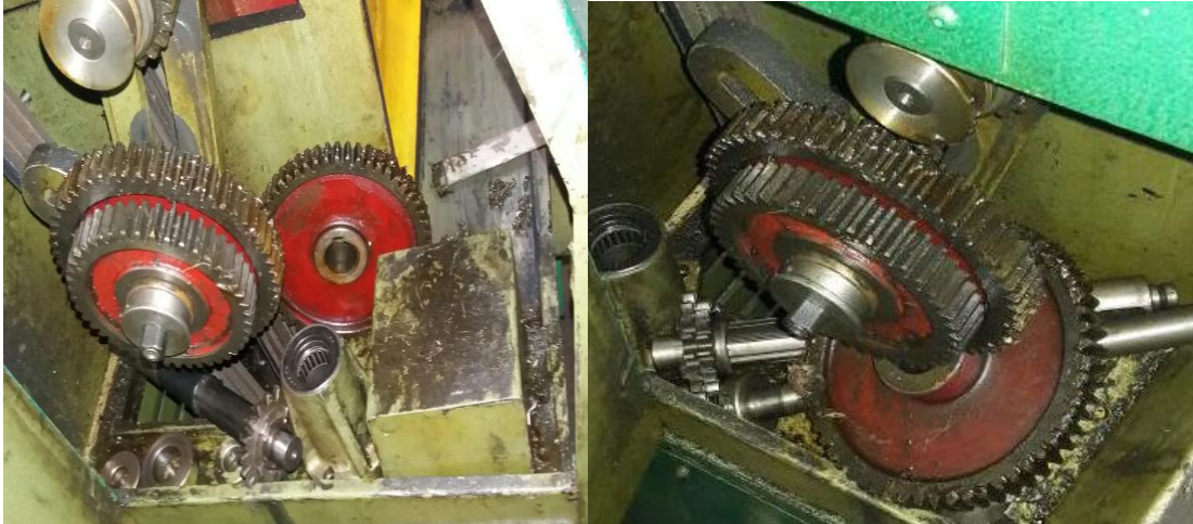
Figura 37 – Transmissão do eixo-árvore para caixa de avanço – Parcialmente desmontado (Antes).
