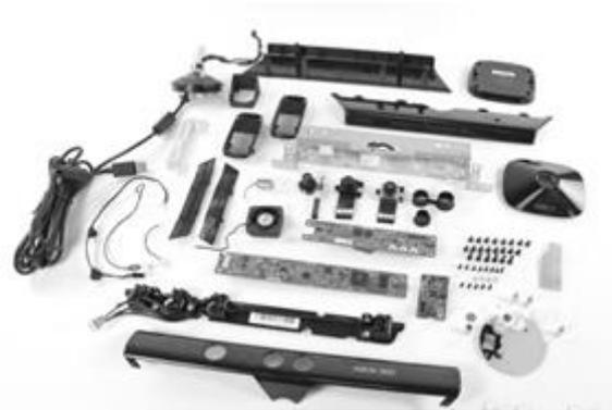
Figura 15: Kinect Desmontado
