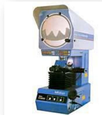
O projetor possui uma mesa de coordenadas móvel com dois cabeçotes micrométricos, ou duas escalas lineares, posicionados a 90°. Ao colocar a peça que será medida sobre a mesa, obtemos na tela uma imagem ampliada, pois a mesa possui uma placa de vidro em sua área central que permite que a peça seja iluminada por baixo e por cima simultaneamente, projetando a imagem na tela do projetor.
