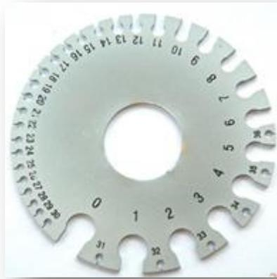
Os modelos são de aço temperado. Caracterizam-se por uma série de entalhes. Cada entalhe corresponde, rigorosamente, a uma medida de diâmetro de fios ou espessuras de chapas, conforme a fieira adotada.
