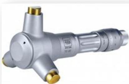
Este tipo de micrômetro é usado exclusivamente para realizar medidas em superfícies cilíndricas internas, permitindo leitura rápida e direta.
