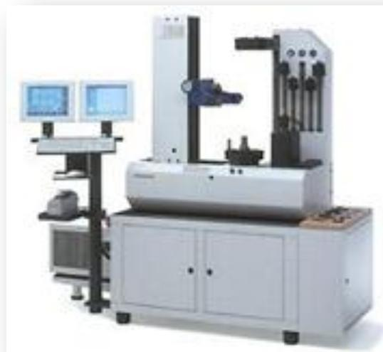
Estas máquinas encontram grande aplicação nos laboratórios de metrologia, em trabalhos como calibração de calibradores e medição de peças em geral.
