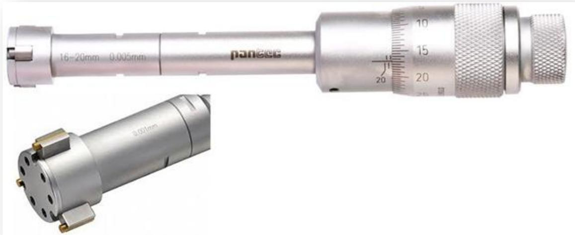
A leitura em micrômetros internos de três contatos é realizada da seguinte maneira:
