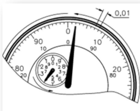
**Observação:** Antes de tocar na peça, o ponteiro do relógio comparador fica em uma posição anterior a zero. Assim, ao iniciar uma medida, deve-se dar uma pré-carga para o ajuste do zero. Colocar o relógio sempre numa posição perpendicular em relação à peça, para não incorrer em erros de medida.
