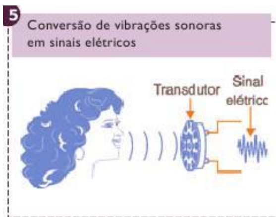
Figura 8 – Conversão de vibrações sonoras em sinais elétricos
