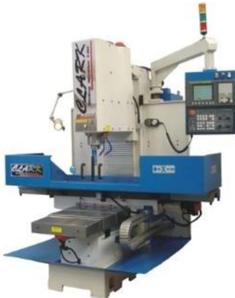
Figura 4- Fresadora Ferramenteira
