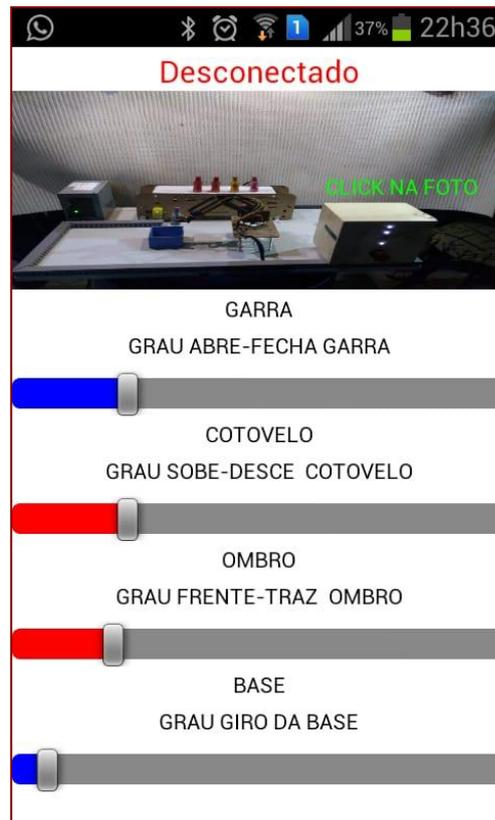
Figura 51 – Aplicativo para posicionamento do braço.
