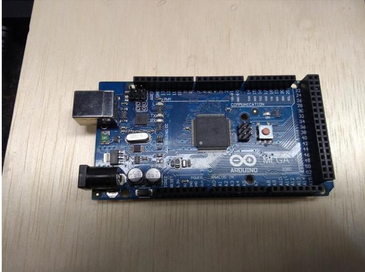
Figura 38 – Arduino Mega.
