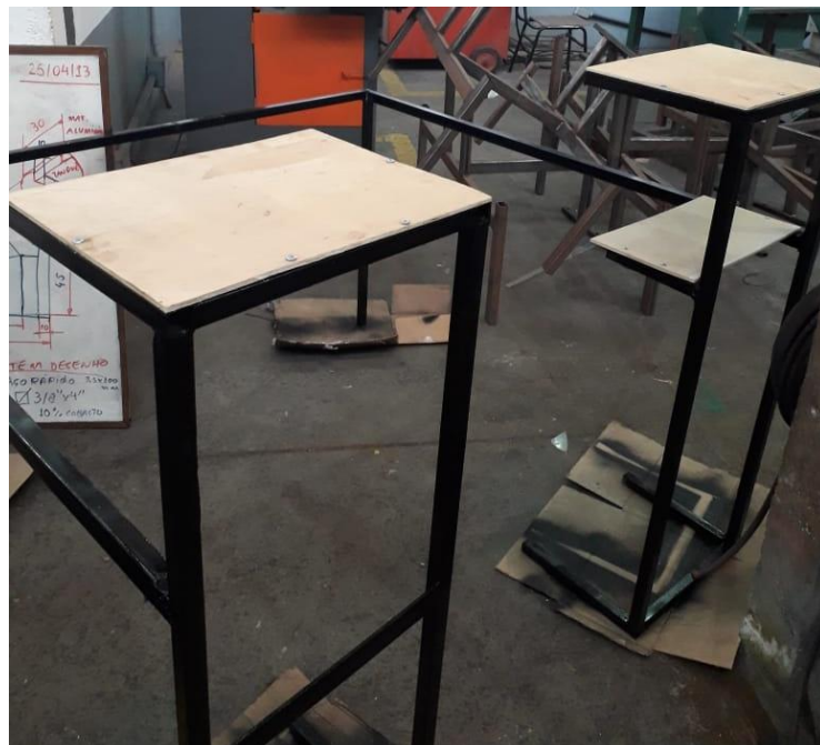
Figura 26 – Estrutura principal finalizada
