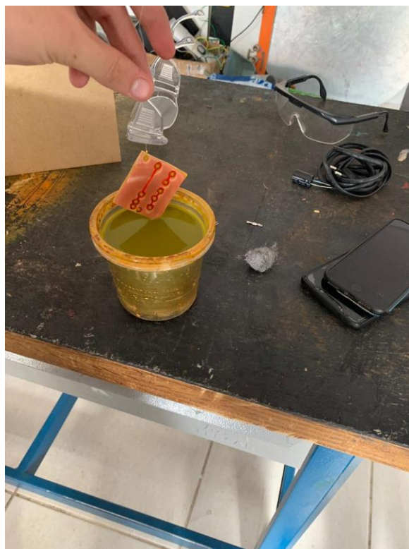
Figura 6/7- Placa de circuito impresso sendo desenhada e corroída
