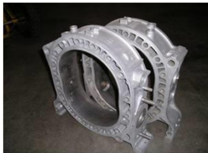
Figura 4 - Câmara de combustão
