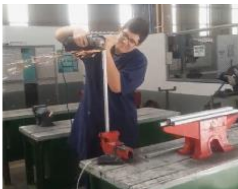
Figura 25 – acabamento das barras da estrutura com utilização de esmeril.
