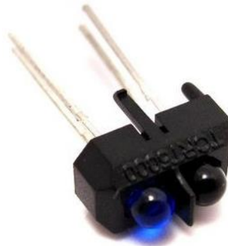
Figura 3 – Sensor utilizado no tabuleiro Tic Tac toe (modelo TCRT 5000)
