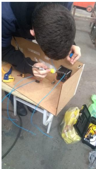
Figura 49 – Solda dos cabos no joystick
