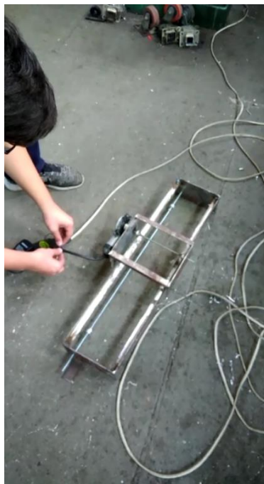
Figura 32 – Teste do carro em movimento. Observa-se o motor montado com o eixo onde se encontram as rodas.
