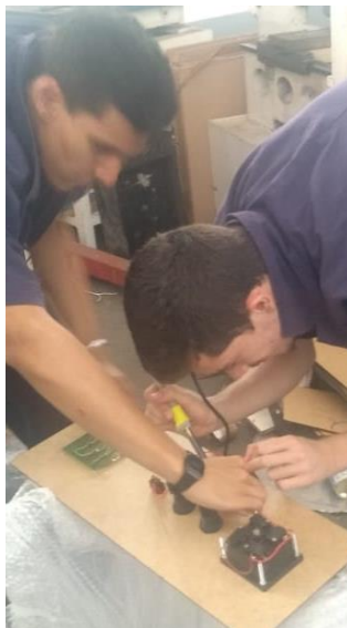
Figura 50 – solda dos cabos nos botões e chaves
