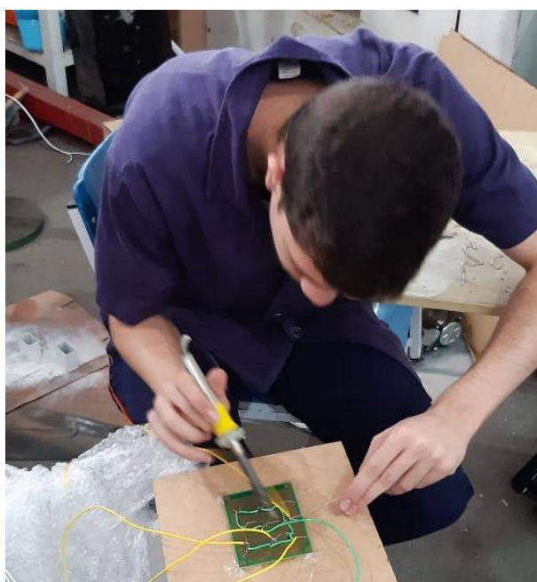
Figura 48 – Solda dos cabos nos LEDs
