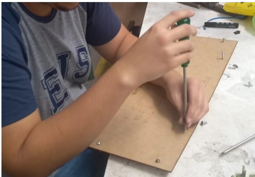
Figura 36 – Montagem do painel com parafusos
