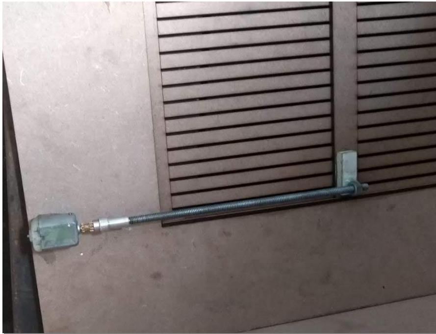
Figura 15 Janela com Motor e Suporte Fonte: Autor do Projeto, 2019
