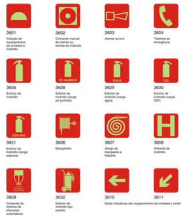
Figura 7 - Tipos de sinalização de equipamentos
