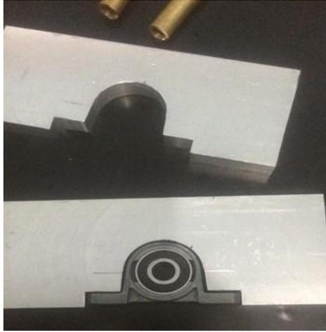
**Figura 14:** Suporte de alumínio feitas na Fresadora
