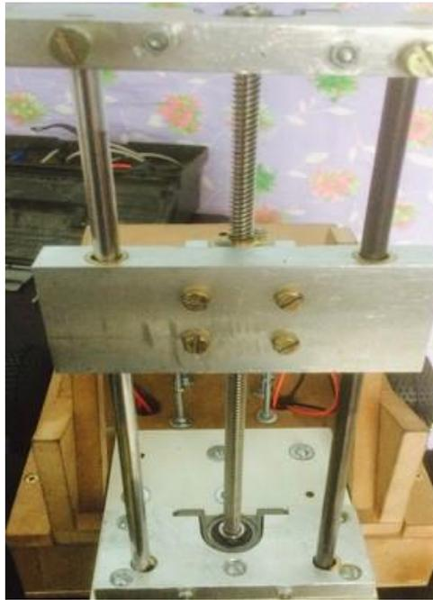
**Figura 16:** Sistema de levantamento fixado na sua determinada posição.
