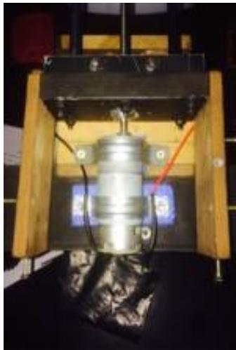
**Figura 17:** Motor de elevação da carga
