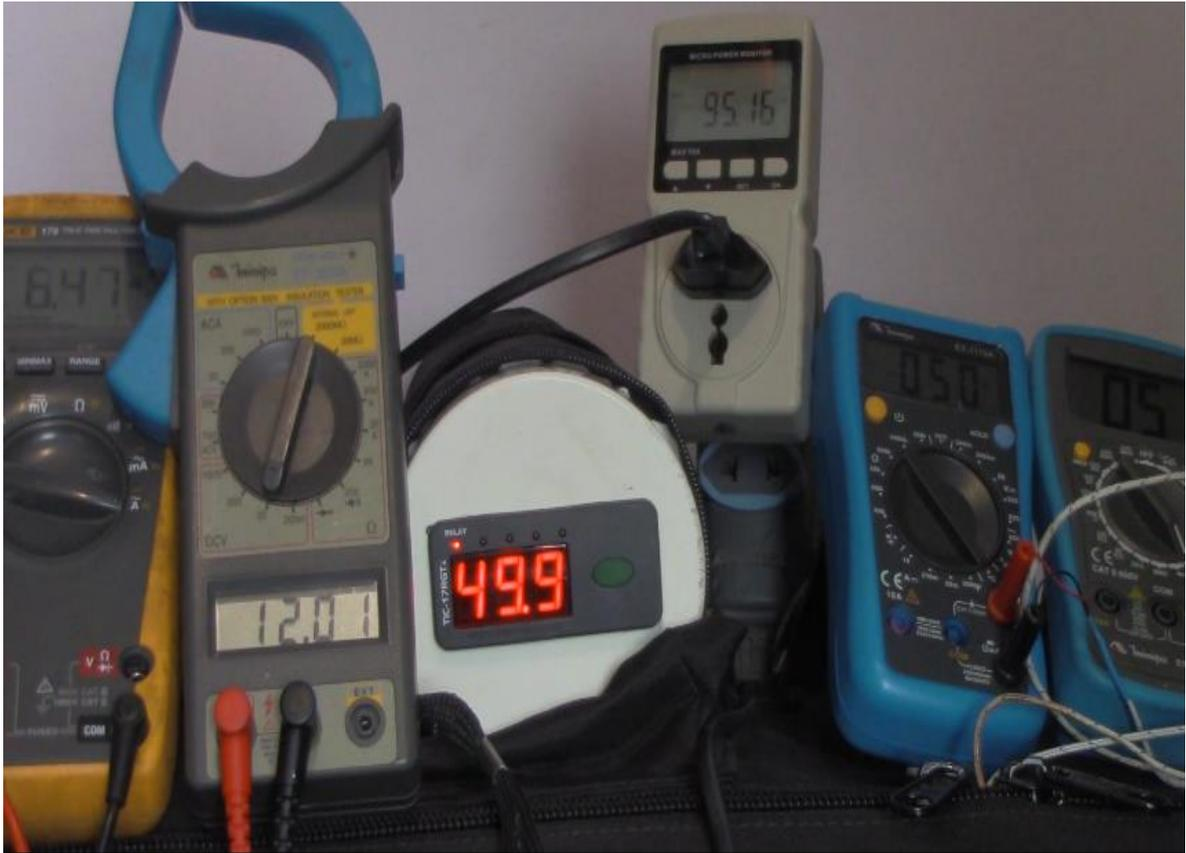
Figura 15 – Teste com controlador Fullgauge modelo TIC-17RGti
