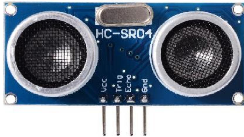
Figura 12 – Sensor ultrassônico
