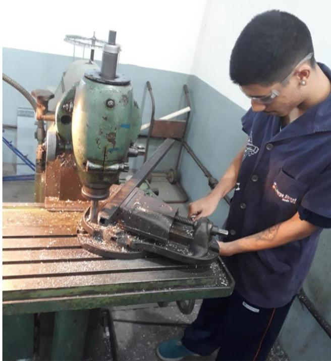
Figura 21 – Utilização da fresadora para furo de encaixe das rodas
