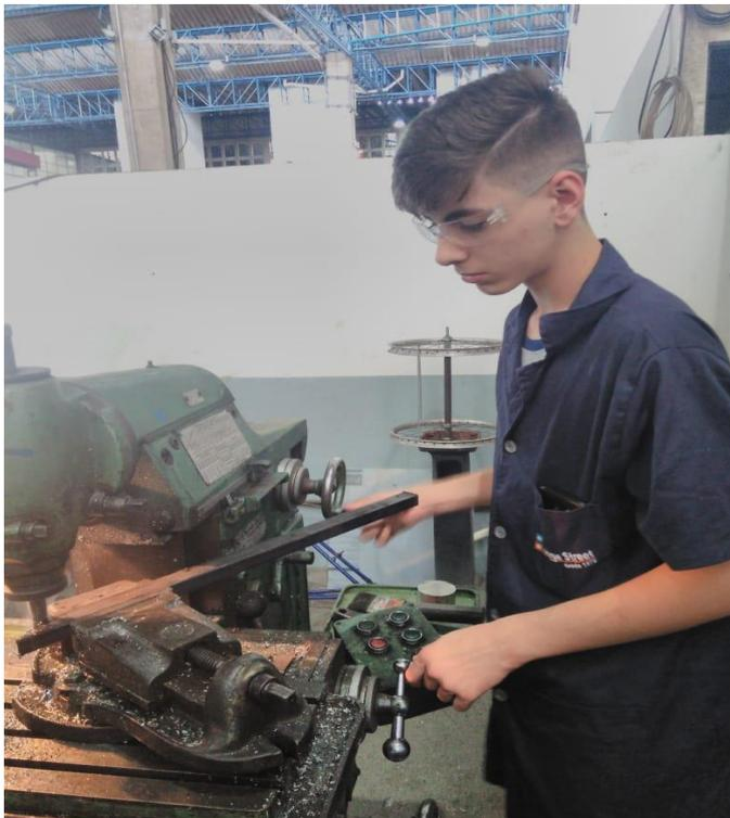
Figura 22 – Utilização da fresadora para furo de encaixe das rodas
