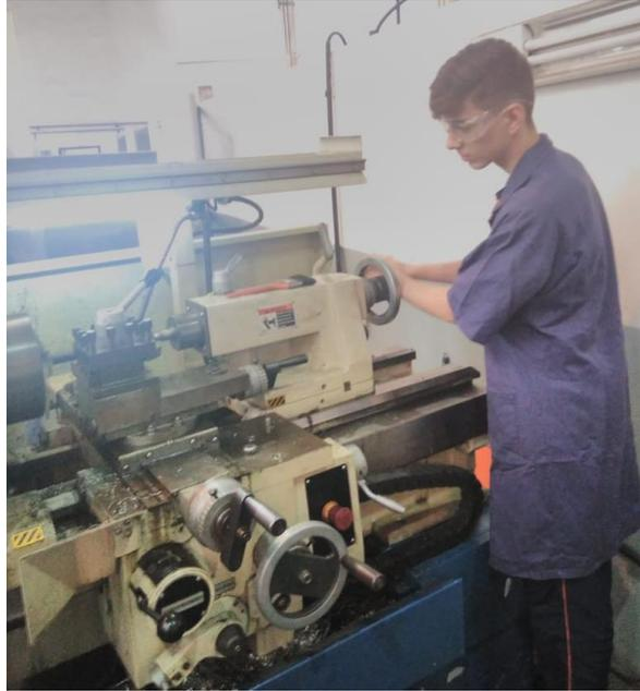
Figura 23 – Utilização do torno para a adaptação das hastes e do motor
