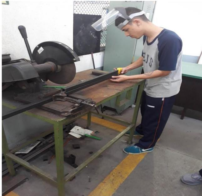
Figura 19 – Medição para o corte das barras de sustentação
