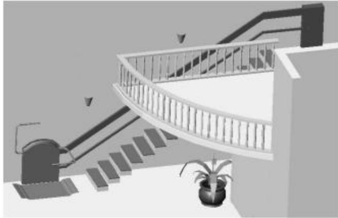
Figura 1.2 – Perspectiva do esboço preliminar da plataforma.
