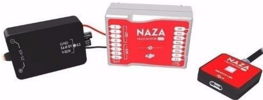
Figura 1: Placa Controladora DJ NAZA LITE
